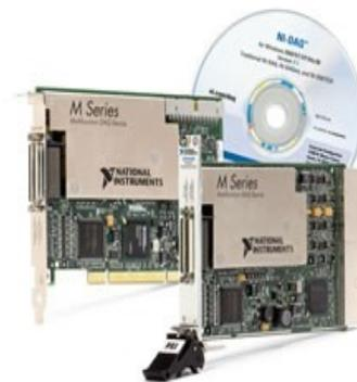
*Ilustración 41: Dos tarjetas con distinto conector (PCI-Express y PXI-Express) y un mismo software para las dos*
