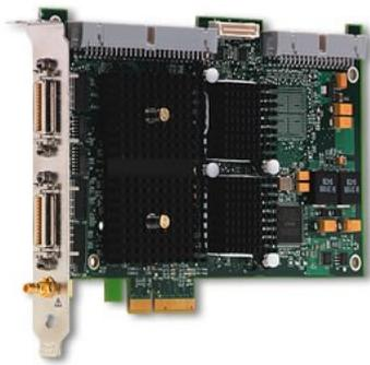
*Ilustración 42: Frame grabber NI PCIe-1429 captura la señal de cualquier cámara que cumpla la norma CameraLink (2800€)*
