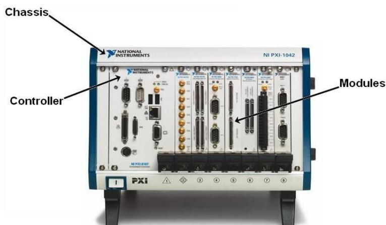
Ilustración 39: Chasis PXI con el controlador (tarjeta más a la izquierda) y las tarjetas (osciloscopios, multímetros, etc)
