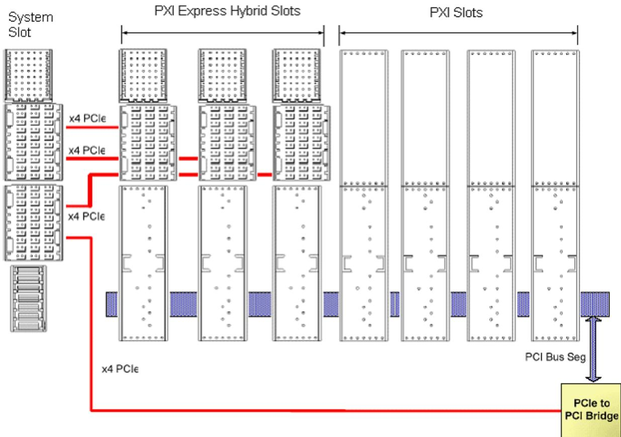
*Ilustración 40: Backplane de un chasis preparado para PXI-Express. Se pueden insertar tanto tarjetas PXI como PXI-Express*
