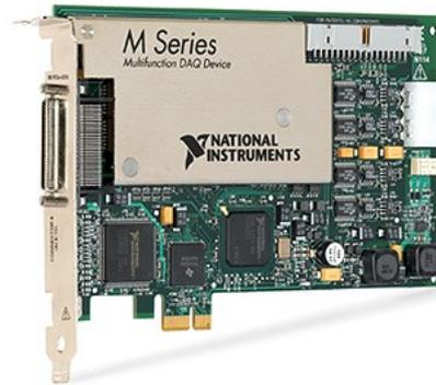
*Ilustración 43: Tarjeta de adquisición NI PCIe-6251 con conector x1 (250MB/s), 16 entradas y 4 salidas analógicas a 16bits 1.25 MSample/s*
